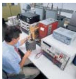
WKA, калибровочная DKD-лаборатория для измерения температуры
