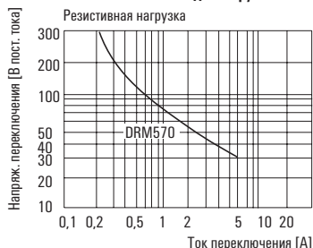
Отключ. способность для нагрузки пост. тока Резистивная нагрузка
