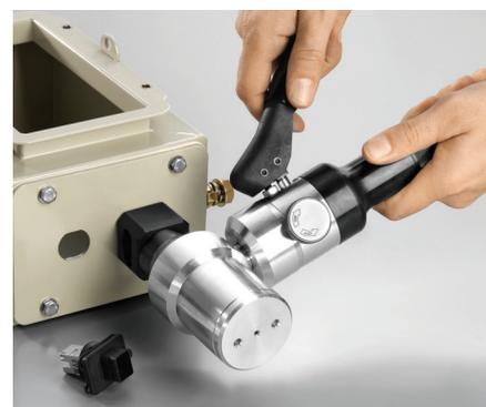
Пробивка отверстий для различных промышленных разъемов Ethernet.
