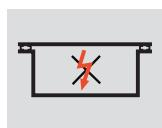
Вид защиты "повышенная взрывобезопасность" предназначен для изделий, у которых не возникает искрообразования при нормальной эксплуатации или в случае неисправности.
