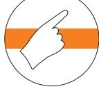
Защищено от проникновения больших твердых предметов диаметром 12,5 мм и более. Защищено от прикосновения пальцами к опасным частям.                                                                           |
