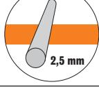
Защищено от проникновения больших твердых предметов диаметром 2,5 мм и более. Защищено от прикосновения инструментом к опасным частям.                                                                        |
