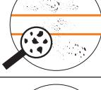
Пылезащищенное оборудование, проникновение пыли не предотвращается полностью, но пыль не может проникать в таком количестве, которое способно негативно повлиять на надлежащее функционирование оборудования. |
