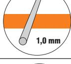
Защищено от проникновения больших твердых предметов диаметром 1 мм и более. Защищено от прикосновения проводом к опасным частям.                                                                              |
