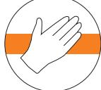
Защищено от проникновения больших твердых предметов диаметром 50 мм и более. Защищено от прикосновения ладонью к опасным частям.                                                                               |
