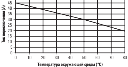
Кривая ухудшения характеристик при умеренной вентиляции и работе в течение 50 % времени
