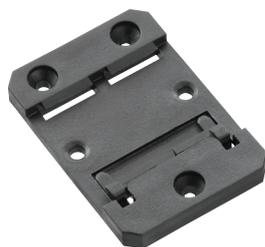
Монтажный адаптер MTA 45 позволяет надежно присоединять различные модули к клеммной рейке. Адаптер изготовлен из полиамида, упрочненного стеклопластиком, и обеспечивает стабильное и надежное крепление к клеммной рейке. При установке он просто защелкивается на рейке, а для снятия нужно поднять и повернуть модуль. Для этих операций инструменты не требуются.
